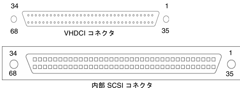
図 B-1 VHDCI および内部 SCSI コネクタ
