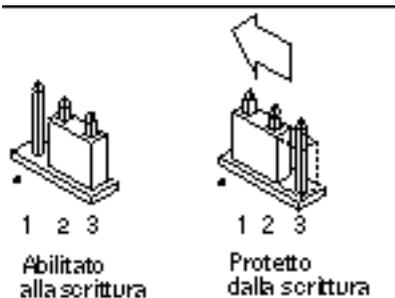
*Figura 4-6* Impostazione del jumper di protezione/abilitazione alla scrittura in posizione protetta
