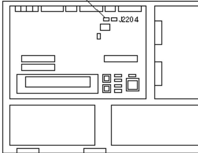
*Figura 4-2* Posizione del jumper di protezione/abilitazione alla scrittura sulla scheda madre dei sistemi Sun Ultra 1 Creator Series
