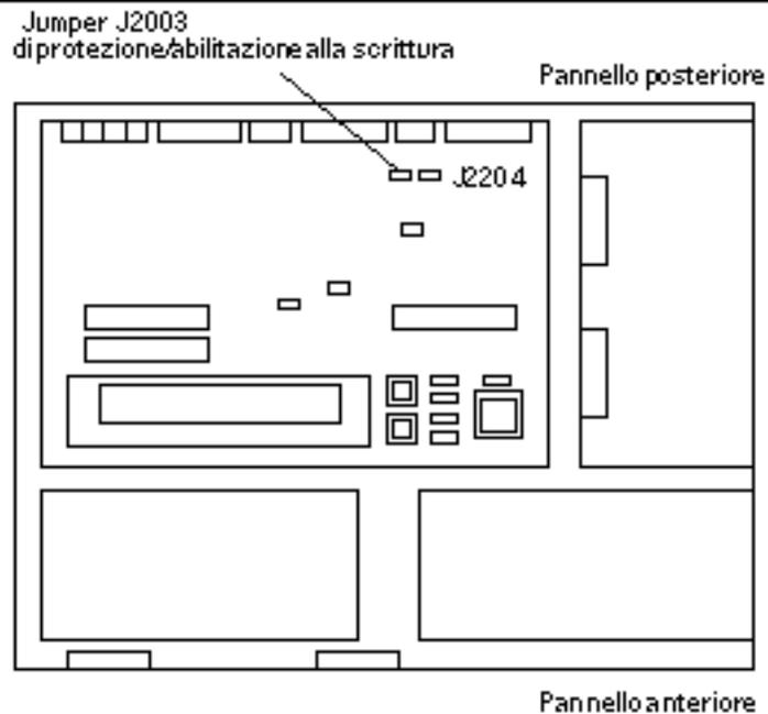
*Figura 4-1* Posizione del jumper di protezione/abilitazione alla scrittura sulla scheda madre dei sistemi Sun Ultra 1
