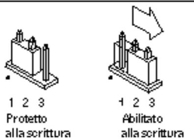
Figura 4-4 Impostazione del jumper di protezione/abilitazione alla scrittura nella posizione di abilitazione alla scrittura
