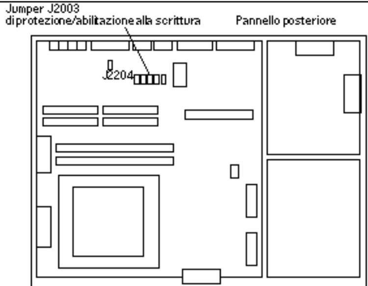
Figura 4-3 Posizione del jumper di protezione/abilitazione alla scrittura sulla scheda madre dei sistemi Sun Ultra 2
