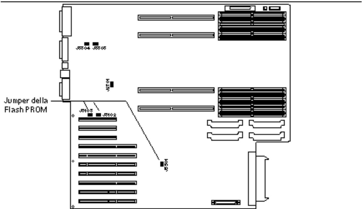
Figura 4-8 Posizione dei jumper della Flash PROM sui sistemi Sun Enterprise 450 e sulle workstation Sun Ultra 450
