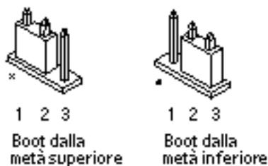
Figura 4-7 Impostazione del jumper di controllo del boot per l'esecuzione del boot dalla metà inferiore o dalla metà superiore
