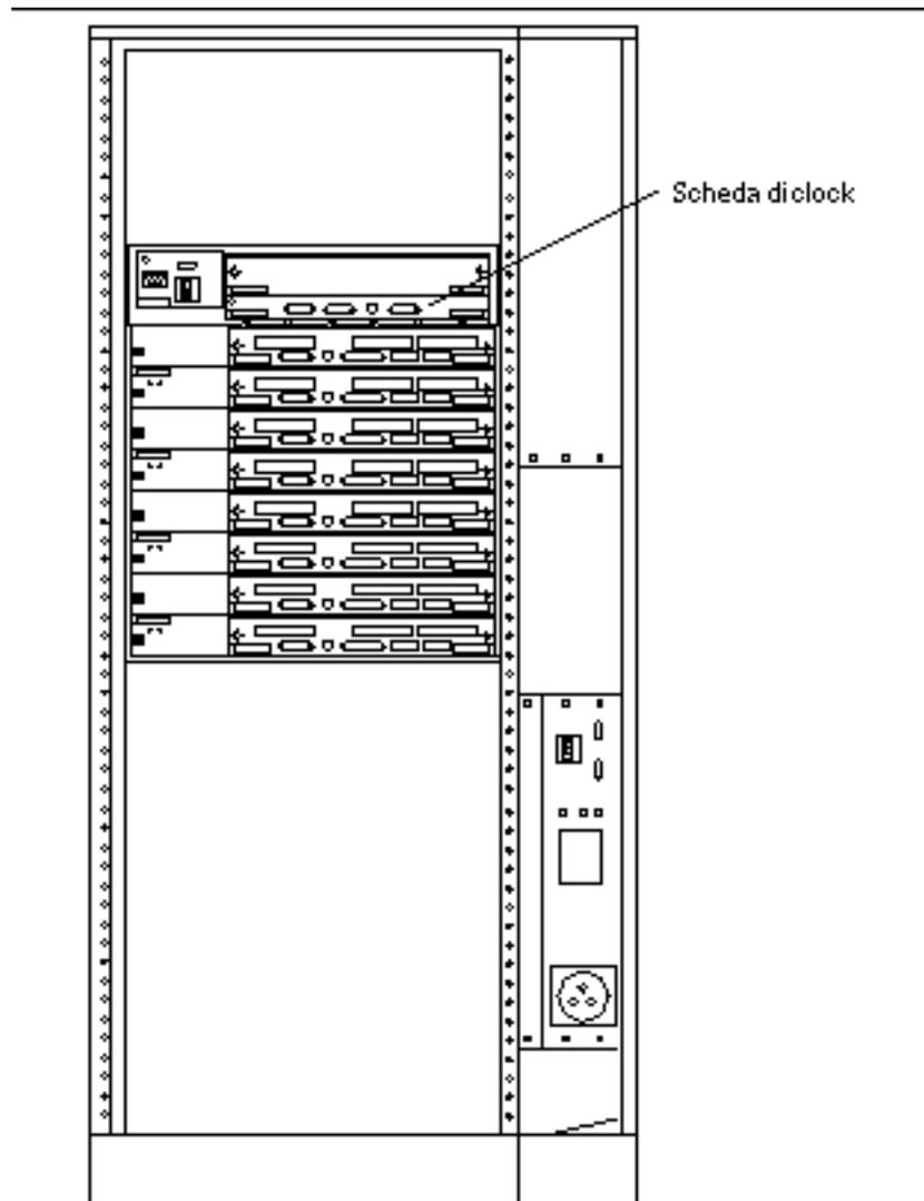
Figura 5-2 Vista posteriore del sistema Sun Enterprise 6000
