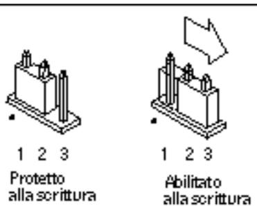
Figura 4-9 Impostazione del jumper J3103 di protezione/abilitazione alla scrittura sui sistemi Sun Enterprise 450 o Ultra 450
