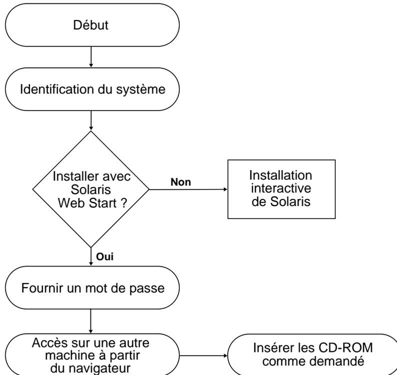
Figure 4-1 Déroulement des opérations en mode client-serveur
