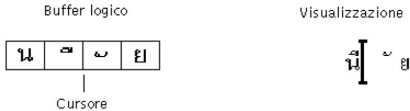
Figura D-3 Buffer logico e visualizzazione prima della cancellazione del testo
