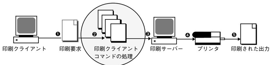
図 1-3 印刷クライアントが資源を調べてプリンタを見つける
