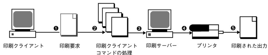
図 1-1 印刷クライアントの処理手順の概要
