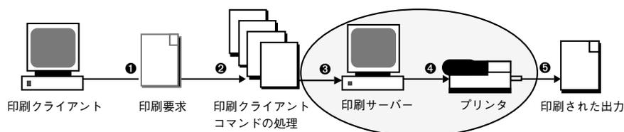
図 1-5 印刷サーバーが印刷要求をプリンタに送信する
