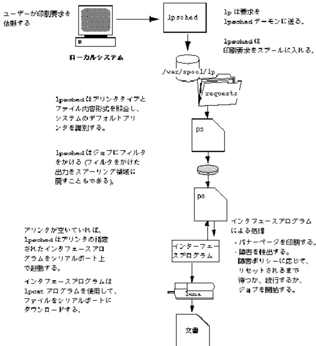
図 7-2 ローカルでの印刷処理
