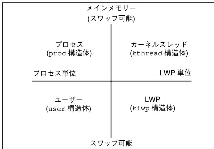
図 24-1 プロセス構造体
