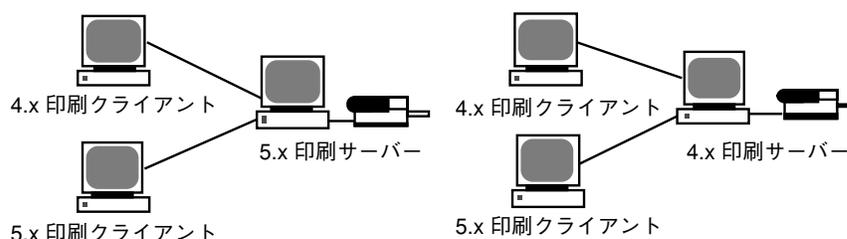
図 2-2 SunOS 4.1 システムと SunOS 5.7 システムからなる印刷構成の例
