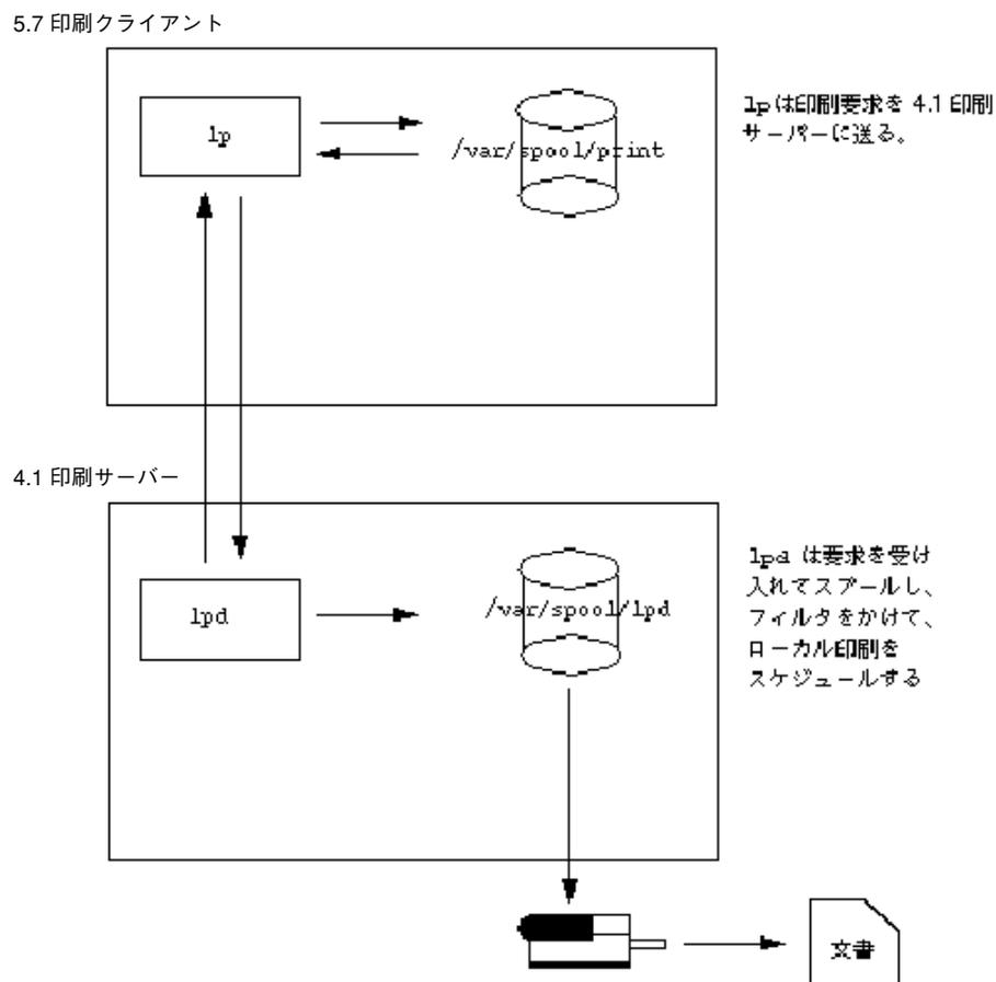
図 7-3 SunOS 5.7 および互換印刷クライアントと SunOS 4.1 印刷サーバー間のネットワーク印刷
