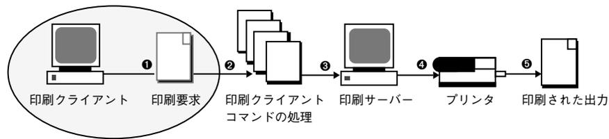
図 1-2 ユーザーが印刷クライアントから印刷要求を発行する
