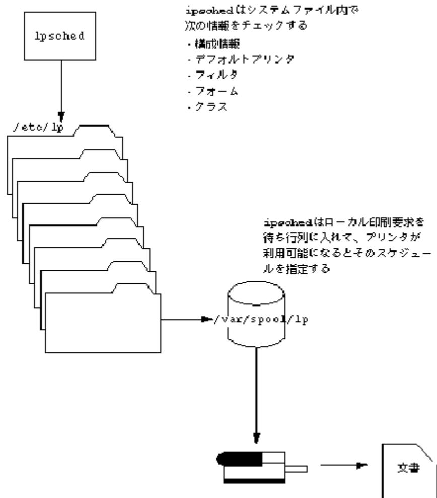
図 7-1 lpsched デーモンによるローカル印刷要求のスケジューリング方法
