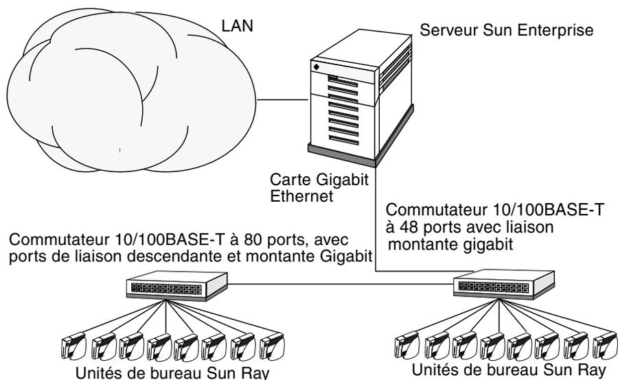
**FIGURE 1-4** Scénario d'un déploiement de faible envergure
