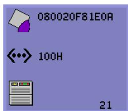
Définition : L'unité de bureau a détecté la porteuse Ethernet mais n'a pas encore reçu ses paramètres initiaux ni son adresse IP de DHCP. L'affichage de cette icône est une phase normale du démarrage, l'icône ne reste en général affichée que quelques secondes.
