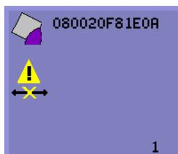
Définition : l'unité de bureau a réussi l'autotest à la mise sous tension mais n'a pas encore détecté de signal Ethernet. L'affichage de cette icône est une phase normale du démarrage, l'icône ne reste en général affichée que quelques secondes.
