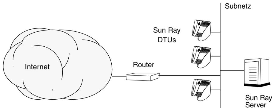
**ABBILDUNG 6-2** Freigegebenes Netzwerk mit Sun Ray-DTUs ohne Routing
