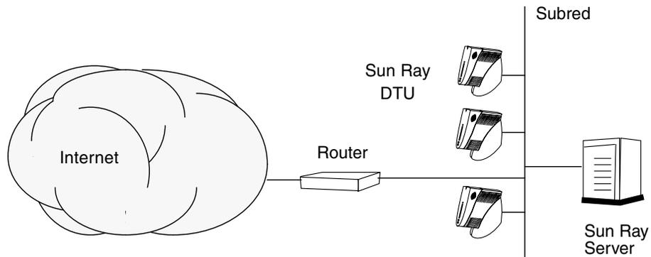
Algunas de las últimas configuraciones utilizan redes compartidas con enrutamiento, como se ilustra, de forma simplificada, en la siguiente figura.
