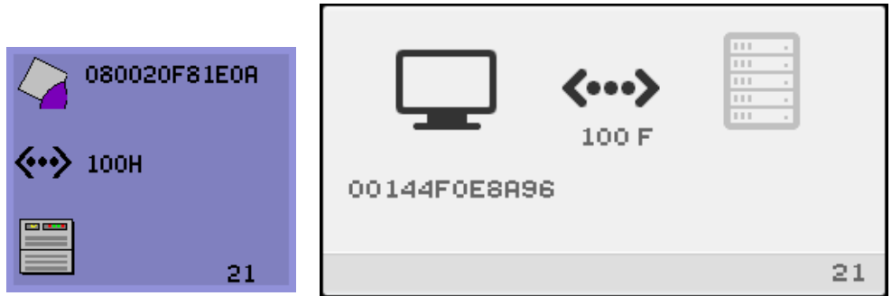
FIGURE B-3 Connexion réseau vérifiée
