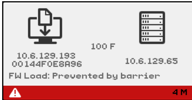
FIGURE B-15 L'icône OSD 4 affiche les messages d'erreur du téléchargement du microprogramme
