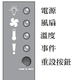
圖 5-2 前方面板上的機架蓋 LED 和重設按鈕
