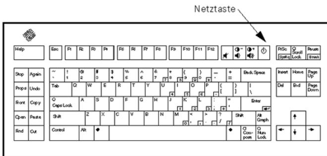
ABBILDUNG 23–8 Standort von Power Key bei der Sun Compact Compact Tastatur
