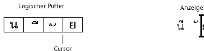
**ABBILDUNG D-2** Logische Zwischenspeicherung und Anzeige nach dem Einfügen von Text
