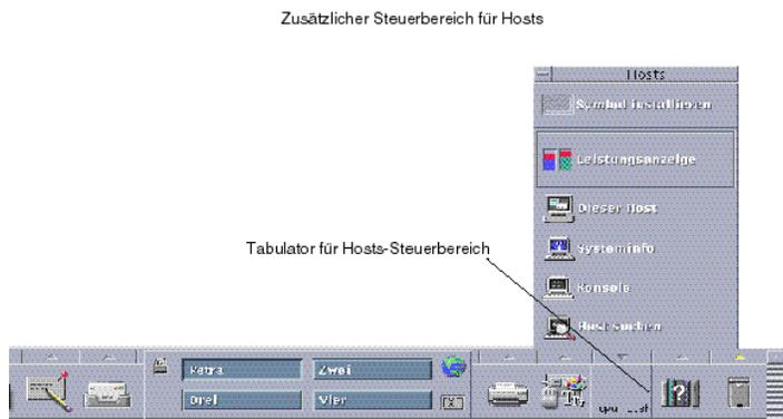
ABBILDUNG 4-1 Hauptsteuerbereich mit einem geöffneten zusätzlichen Steuerbereich
