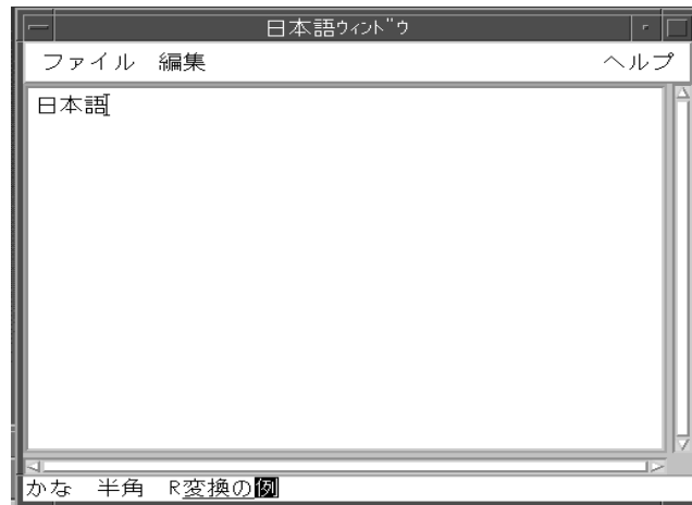
図 1-4 VendorShell ウィジェットでの OffTheSpot プリエディットの例 (日本語)
