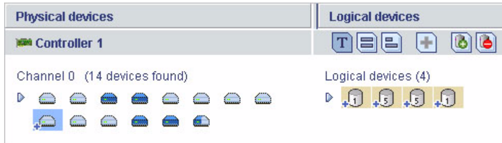
図 6-11 グローバルホットスペアの識別 - プラス記号が横に付いたアイコン
