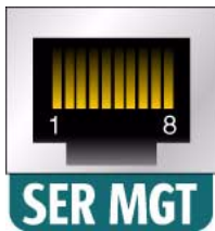
FIGURA A-3 Numeración de las patillas del puerto serie de gestión
