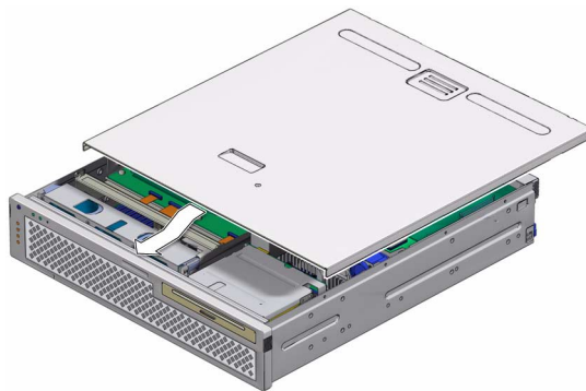
FIGURA 7-3 Instalación de la cubierta superior
