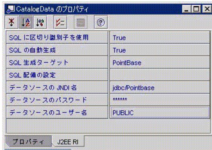
図 3-3 EJB モジュールのサーバー固有プロパティ
