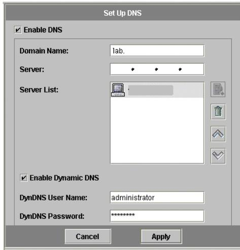
FIGURE 3-4 Panneau Set Up DNS (Paramétrage DNS)
