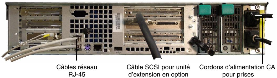
FIGURE 2-2 Branchement des câbles d'alimentation CA du serveur Sun StorEdge 5210 NAS
