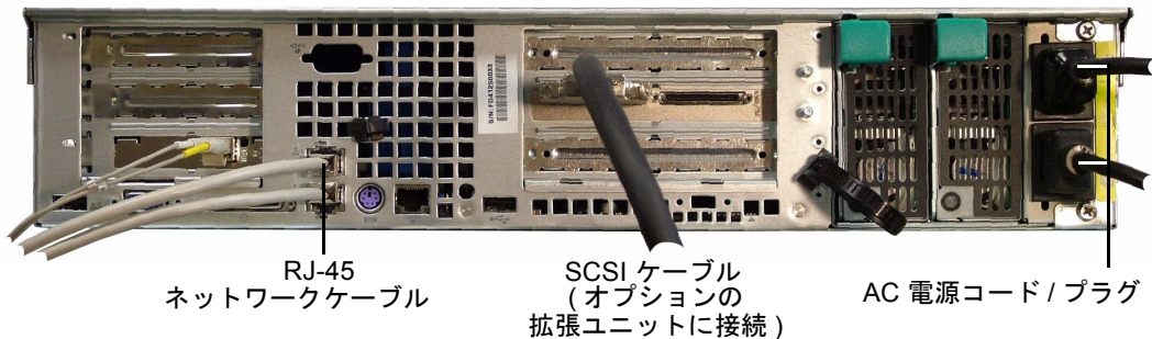
図 2-2 Sun StorEdge 5210 NAS の AC 電源ケーブルの接続
