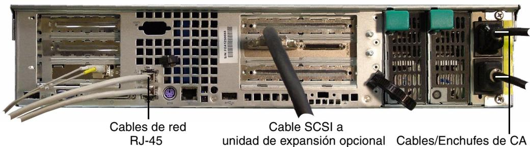
FIGURA 2-2 Conexión de los cables de alimentación de CA de Sun StorEdge 5210 NAS
