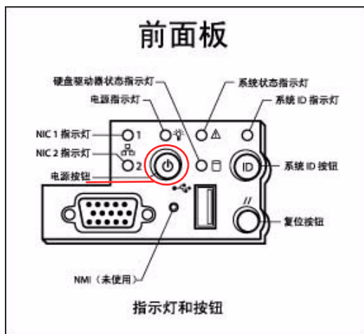
图 2-3 电源开关和前面板明细
