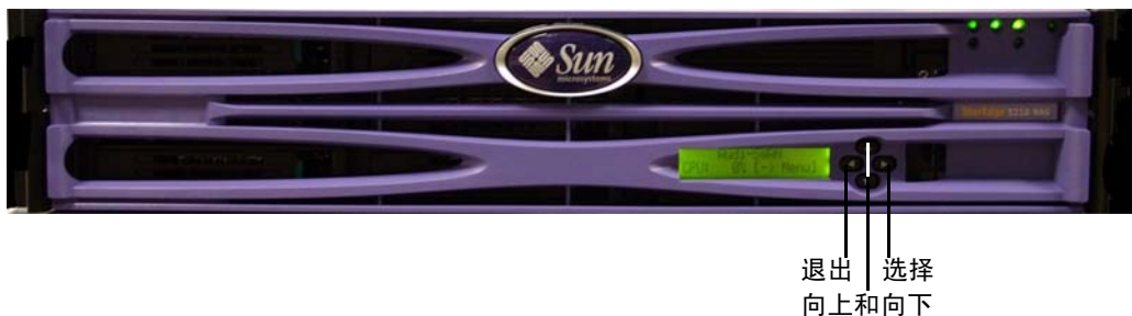
图 2-5 LCD 面板控件
