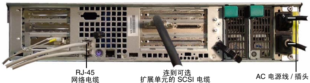
图 2-2 连接 Sun StorEdge 5210 NAS AC 电源线
