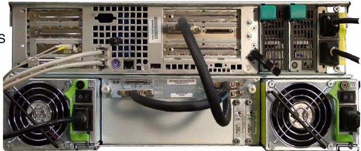
**FIGURA 2-9** Conexión de Sun StorEdge 5210 NAS y una única unidad de expansión
