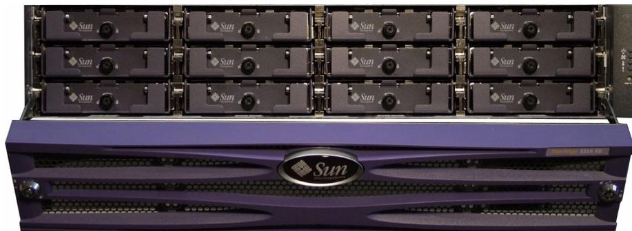
FIGURA 2-5 Unidad de expansión con la placa frontal extraída
