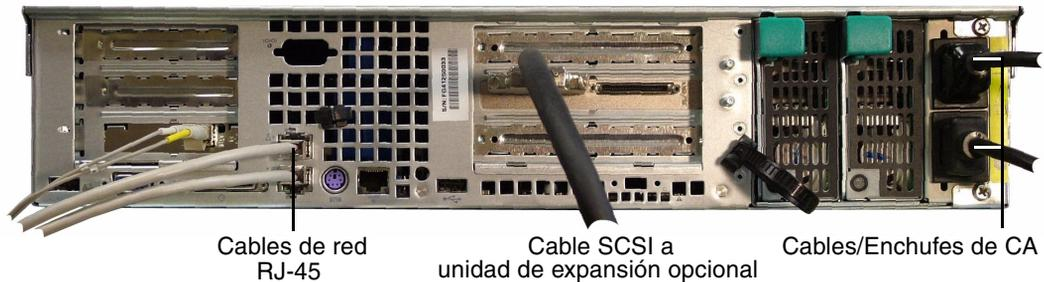
FIGURA 2-15 Conexión de los cables de alimentación de CA de Sun StorEdge 5210 NAS
