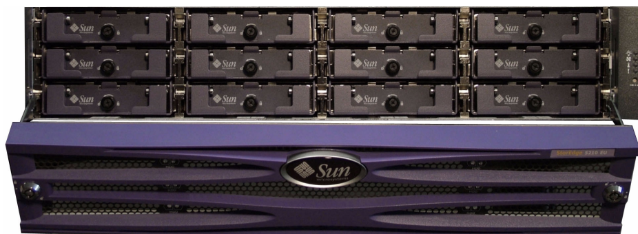
図 2-5 正面カバーを取り外した状態の拡張ユニット
