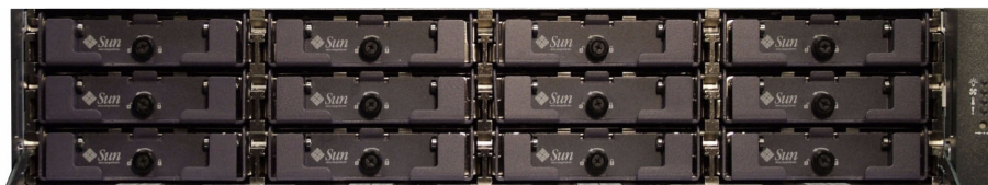
図 3-8 正面カバーを取り外した状態の拡張ユニット
