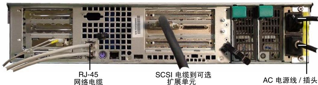
图 2-15 连接 Sun StorEdge 5210 NAS AC 电源电缆
