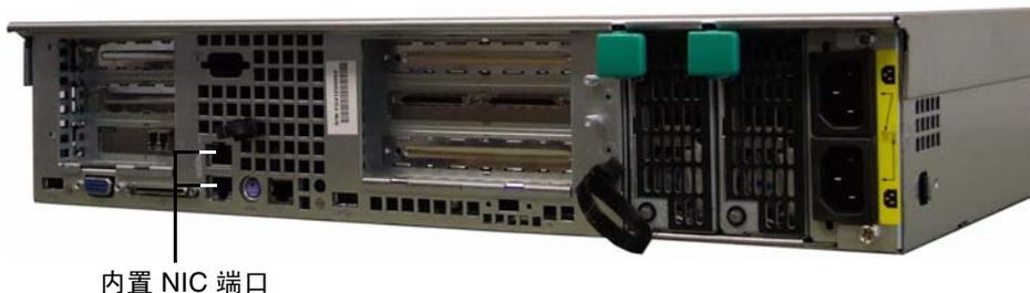
图 3-2 Sun StorEdge 5210 NAS 网络接口卡端口
