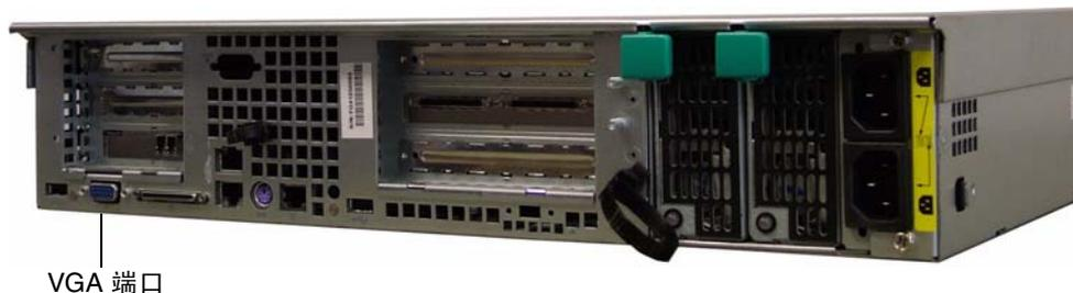
图 3-7 Sun StorEdge 5210 NAS VGA 端口
