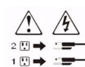
**Attention** – Pour mettre un système équipé de plusieurs cordons d'alimentation hors tension, il est nécessaire de débrancher tous les cordons d'alimentation.
