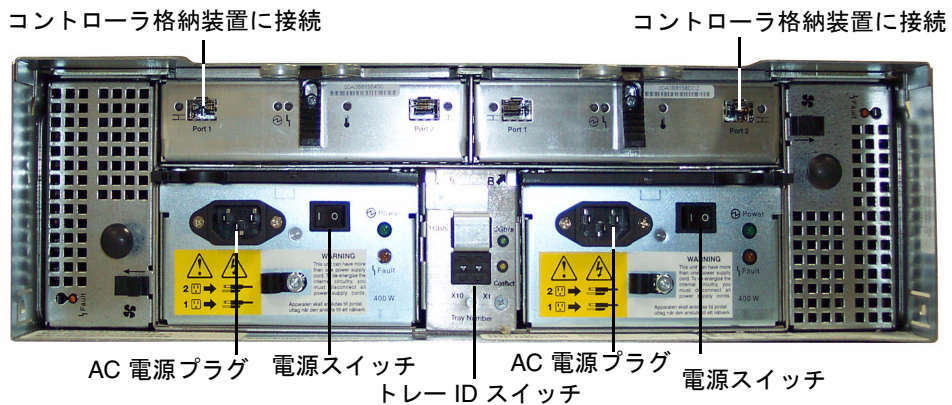
図 1-7 Sun StorEdge 5300 EU F 拡張格納装置の背面パネル
