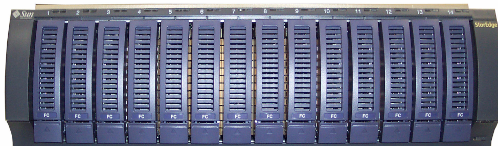
図 1-4 ファイバチャネルディスクドライブが取り付けられた Sun StorEdge 5300 RAID EU コントローラ格納装置の正面
