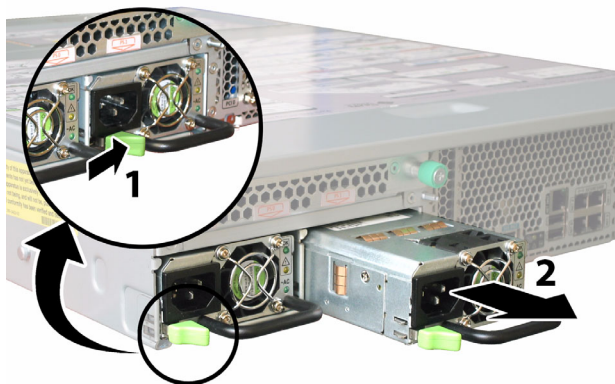
図 12-12 電源装置の取り外し
