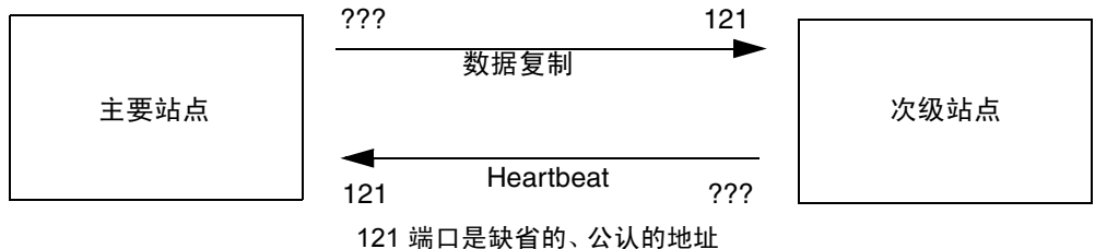
图 1 Remote Mirror 使用的 TCP 端口地址
