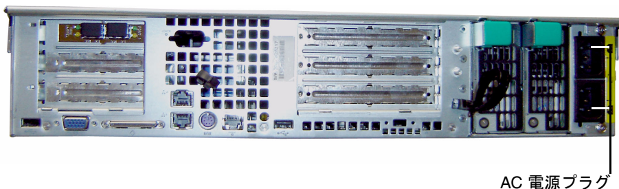
図 2-3 Sun StorEdge 5310 NAS Appliance の AC 電源ケーブルの接続
