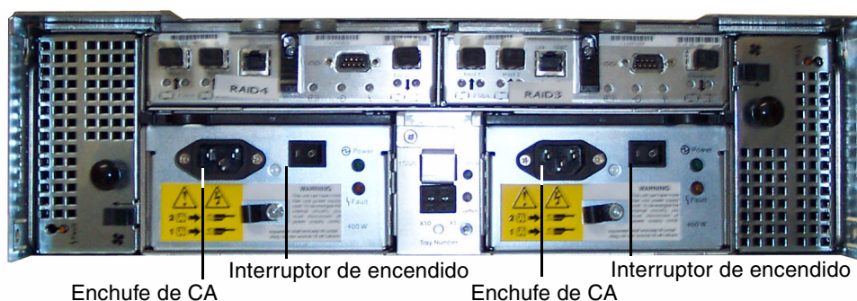
FIGURA 2-2 Panel trasero del armario del controlador
