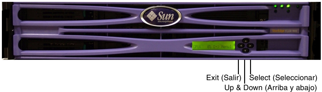
FIGURA 2-6 Controles del panel de LCD
