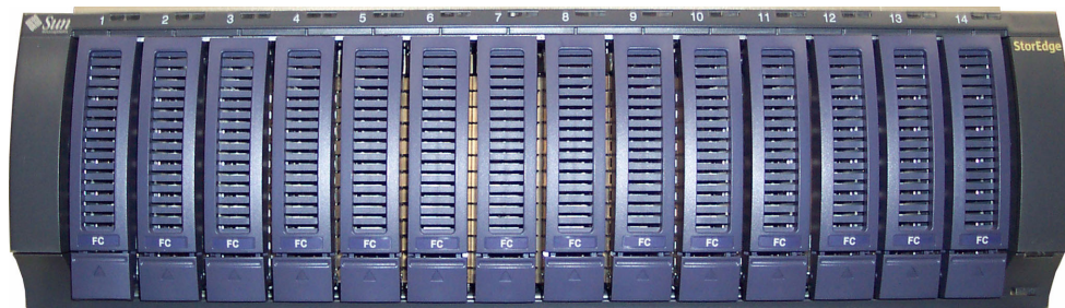
FIGURE 3-4 Avant du boîtier de contrôle d'unités d'extension Sun StorEdge 5300 RAID avec unités de disque Fibre Channel
