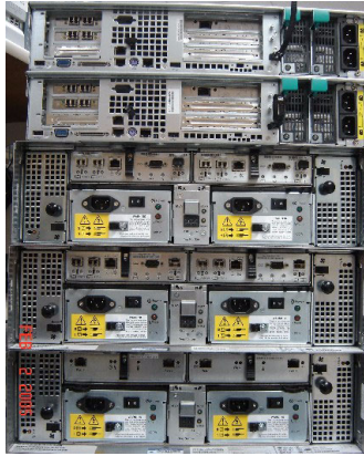
FIGURE 3-8 Ordre de montage en armoire recommandé pour deux boîtiers de contrôle et un boîtier d'extension
