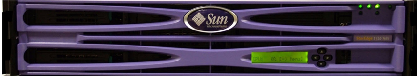
FIGURE 2-1 Vue de face de Sun StorEdge 5310 NAS Appliance
