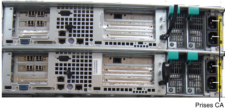
FIGURE 3-23 Branchement des câbles d'alimentation CA du serveur Sun StorEdge 5310 Cluster
