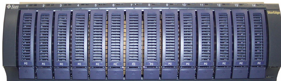
図 2-4 ファイバチャネルディスクドライブが取り付けられた Sun StorEdge 5300 RAID EU コントローラ格納装置の正面
