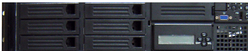
図 2-2 正面カバーを取り外した状態の Sun StorEdge 5310 NAS Appliance
