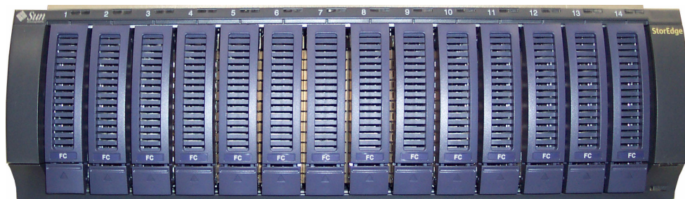
図 3-6 ファイバチャネルディスクドライブが取り付けられた Sun StorEdge 5300 EU F 拡張格納装置の正面
