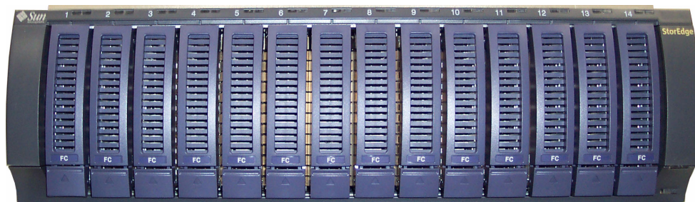
図 2-6 ファイバチャネルディスクドライブが取り付けられた Sun StorEdge 5300 EU F 拡張格納装置の正面
