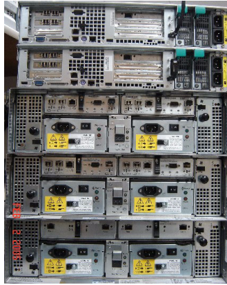
FIGURA 3-8 Orden recomendado para montaje en rack de dos armarios de controlador y un armario de expansión
