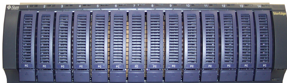
图 2-6 Sun StorEdge 5300 EU F 扩展盒前面板，带有光纤通道磁盘驱动器
