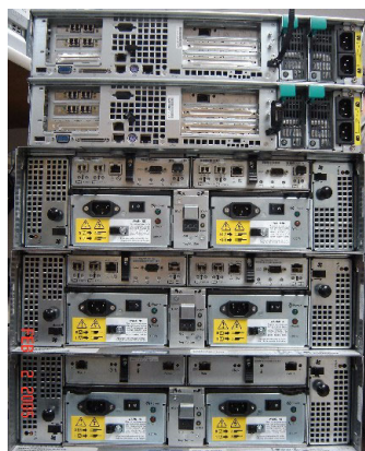
图 3-8 两个控制器盒和一个扩展盒的推荐机架装配顺序
