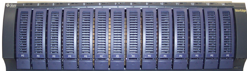
图 3-4 Sun StorEdge 5300 RAID EU 控制器盒前面板，带有光纤通道磁盘驱动器
