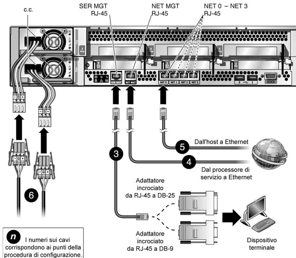
4. (Opzionale) Collegare un cavo Ethernet alla porta Net MGT del server (FIGURA 2) e alla rete a cui dovranno essere collegati il processore di servizio e l'host.
