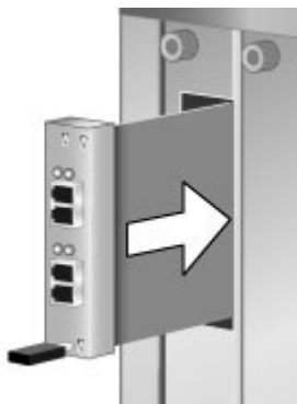
図 2-2 AMC コネクタへの HBA の挿入
