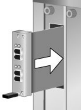
圖 2-2 將 HBA 插入 AMC 連接器
