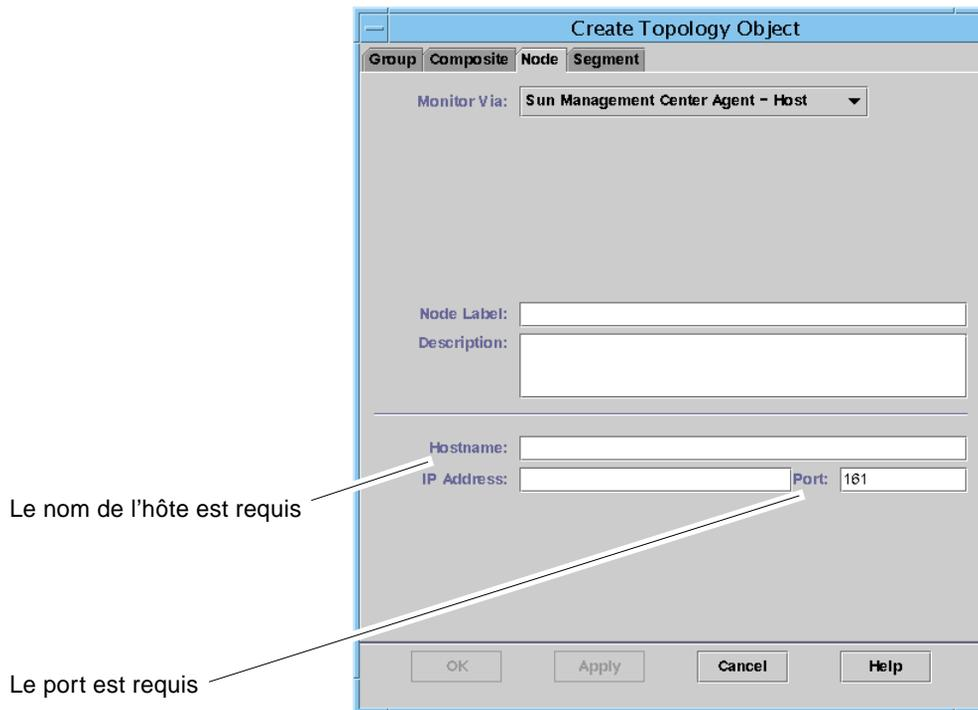
FIGURE 3-2 L'onglet Noeud dans la fenêtre Création d'un objet topologique
