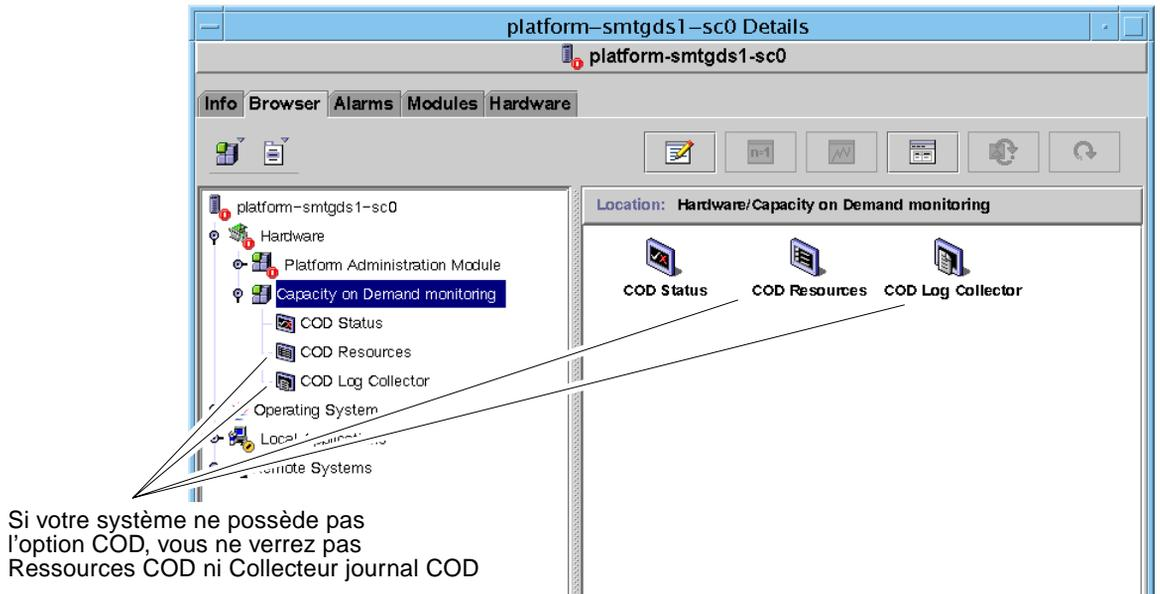
FIGURE 5-5 Icônes de l'option Capacity on Demand
