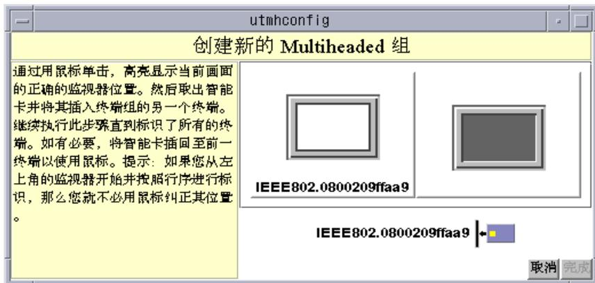
图 9-4 新的 Multihead 组的设置显示屏
