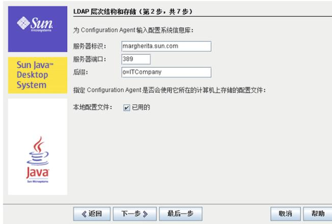
图 3-2 Configuration Agent, LDAP 层次结构和基于文件的存储
