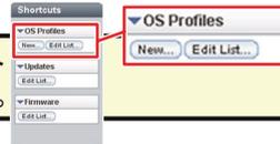
4 ショートカットアイコンをドラッグ&ドロップし、「オペレーティングシステムプロファイルのロード」ウィザードを起動します。
