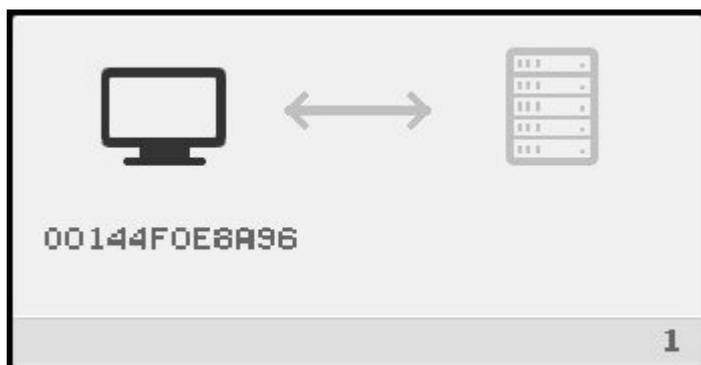
DTU 起動アイコンが、DTU の電源投入時の自己診断はパスしたが、Ethernet 信号が検出されていないことを示しています。アイコンは、通常の起動プロセスの一部として数秒間表示されます。Ethernet 信号が検出されると、[Network Connection Verified OSD](#) が表示されます。
