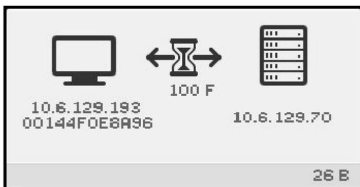
「セッション待機中」OSD は、DTU が X ウィンドウセッションを待機中であることを示します。アイコンは、通常の起動プロセスの一部として数秒間表示されます。
