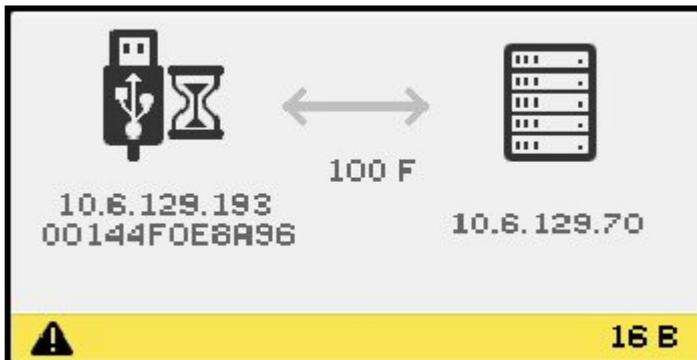
「バスがビジー状態」OSD は、Sun Ray USB バスが高速デバイスからの要求を処理中であるため、キーボードまたはマウスがユーザー入力に応答していない可能性があることを示します。このアイコンは、通常より長い印刷ジョブの間に表示され、ジョブが完了すると消えます。印刷ジョブの取り消しが必要な場合を除いては、
