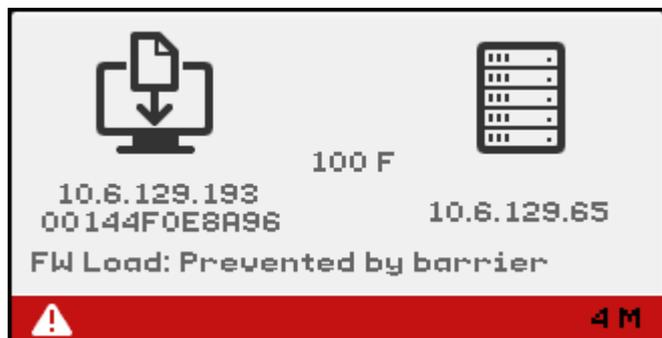
DTU が新しいファームウェアのダウンロードに失敗すると、エラーコード 4 をつけた「ファームウェアダウンロード」アイコンが表示されます。「FW ロード: バリヤーによって妨害されました」というメッセージは、DTU に新しいバージョンのファームウェアがあることを示しています。
