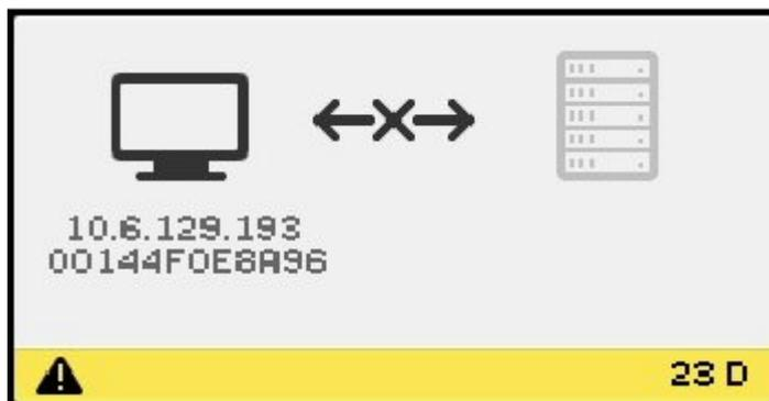
「Ethernet 信号なし」の OSD は、DTU に Ethernet アドレスと IP アドレスがあるが、あとで Ethernet 信号が検出されないことを示しています。
