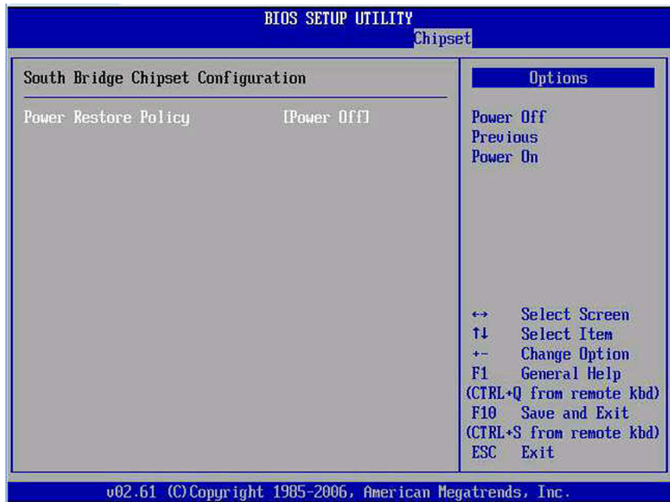
図 28 「South Bridge Chipset Configuration」画面
