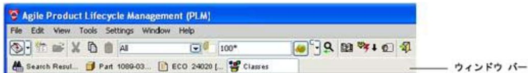
ウィンドウ バーには、開いている各 Java クライアント ウィンドウのボタンがあります。それぞれのボタンには、ウィンドウのタイトルとウィンドウの内容を示すアイコンが表示されます。現在のウィンドウを表しているボタンは押されている状態、つまり凹型で表示されます。別のウィンドウに移動するには、ウィンドウ バー上の該当するボタンをクリックします。
