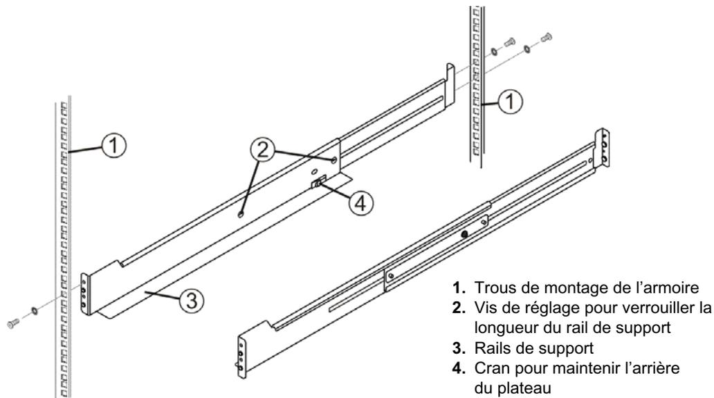
**1. Si nécessaire, insérez des entretoises d'alignement sur les brides des rails de montage.**
