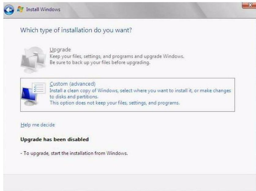
6. 「Installation Type (インストールの種類)」ダイアログボックスで、「Custom (advanced) (カスタム (詳細))」をクリックします。
