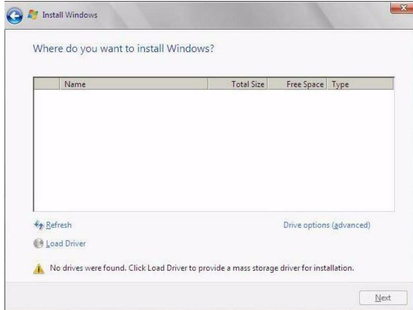
7. 「Windows のインストール場所を選択してください (Where Do You Want to Install Windows)」ダイアログボックスで、次の表のいずれかの作業を実行して、Windows Server オペレーティングシステム版の保存先を指定します。
