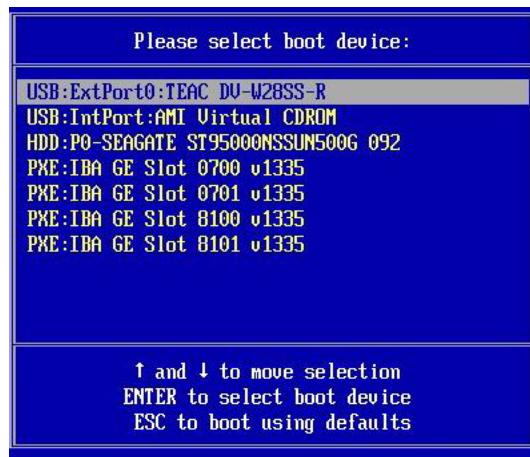
4. 「起動デバイスを選択してください (Please Select Boot Device)」ダイアログボックスで、使用対象として選択した Windows メディアのインストール方法に応じたメニュー項目を選択し、Enter キーを押します。
