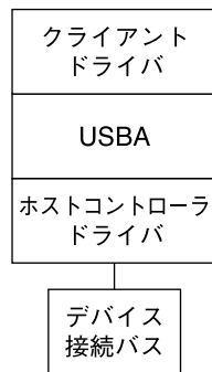
図 7-2 Oracle Solaris USB アーキテクチャー (USBA)
