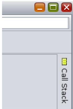
3. 最小化された「呼び出しスタック」アイコンにカーソルを合わせると「呼び出しスタック」ウィンドウが最大化され、カーソルを別のウィンドウに移すと最小化に戻ります。最小化された「呼び出しスタック」アイコンをクリックすると「呼び出しスタック」ウィンドウが最大化され、もう一度クリックするとまた最小化されます。
