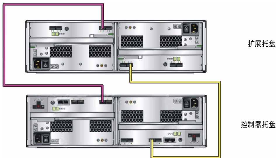
图 2-33 1x2 阵列配置的电缆连接
