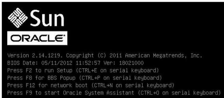
2 BIOS 画面でプロンプトが表示されたら、F2 を押して BIOS 設定ユーティリティーにアクセスします。
