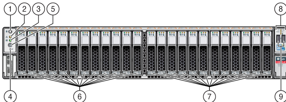
FIGURE 2 Configuration d'un panneau avant avec vingt-quatre unités 2,5 pouces
