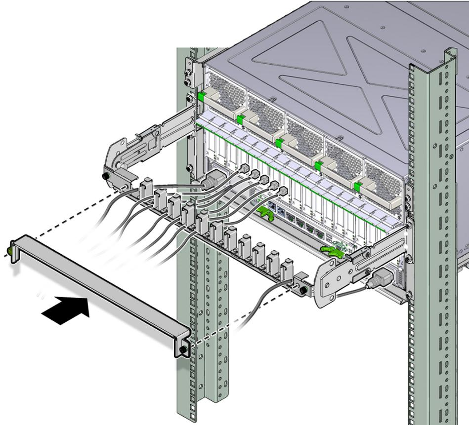
2. Placez les câbles du système dans les logements prévus à cet effet dans le module de fixation des câbles.
