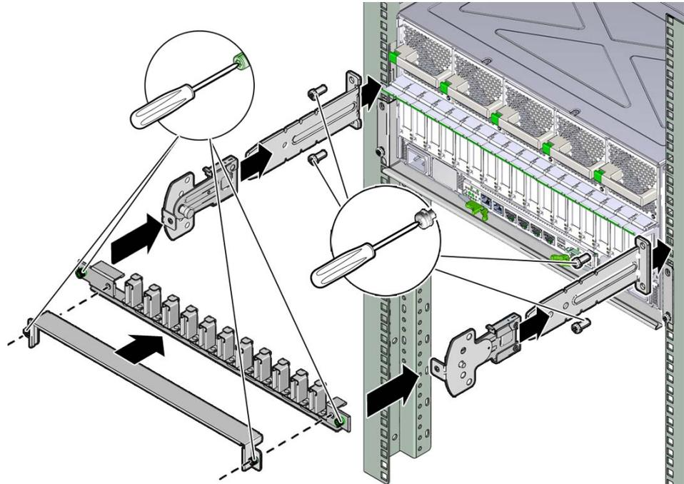
3. Faites glisser les clips pivotants gauche et droit dans les supports en L gauche et droit.
